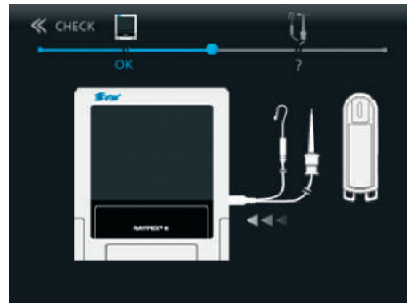
Рис. 32. Подключение измерительного кабеля
