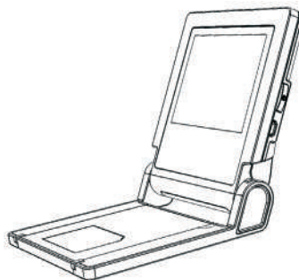
Рис. 1. Неправильная установка прибора
